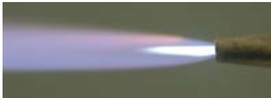
Оптимальный вид пламени горелки для пайки твердым припоем
