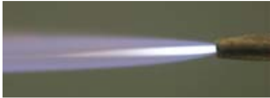
Факел пламени горелки при сбалансированной газовой смеси (ярко синего цвета и небольшой величины)
